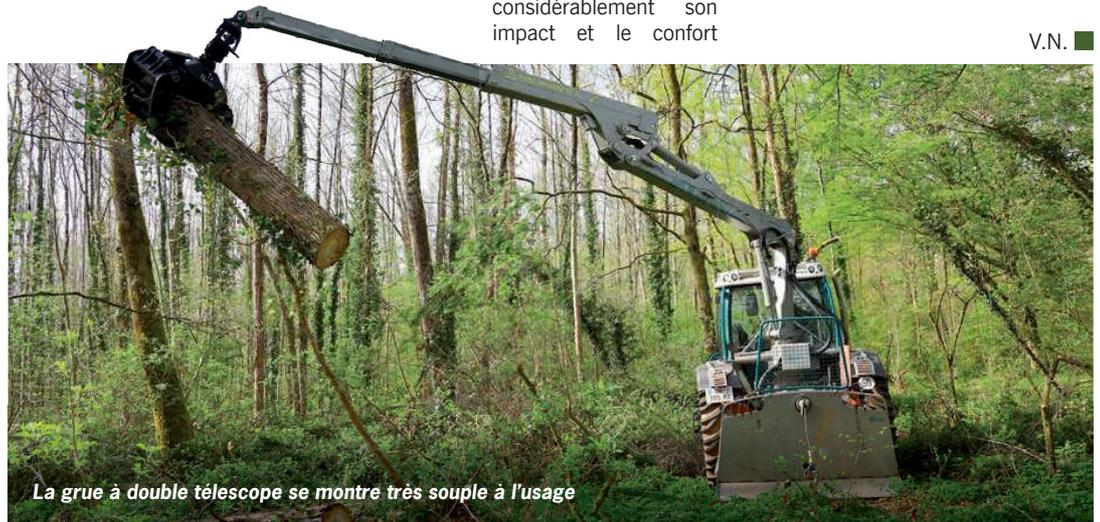
La grue à double télescope se montre très souple à l'usage
