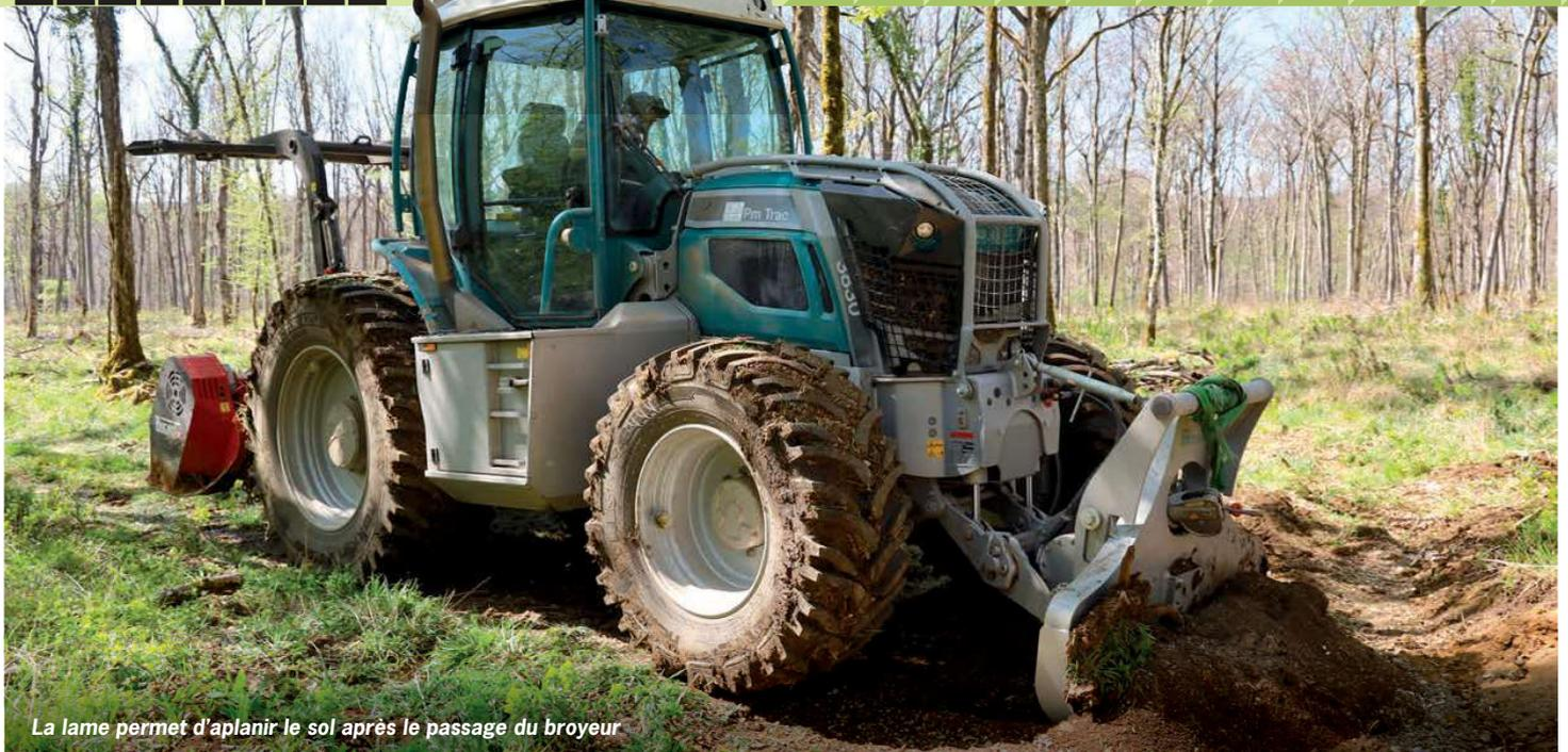
La lame permet d'aplanir le sol après le passage du broyeur
